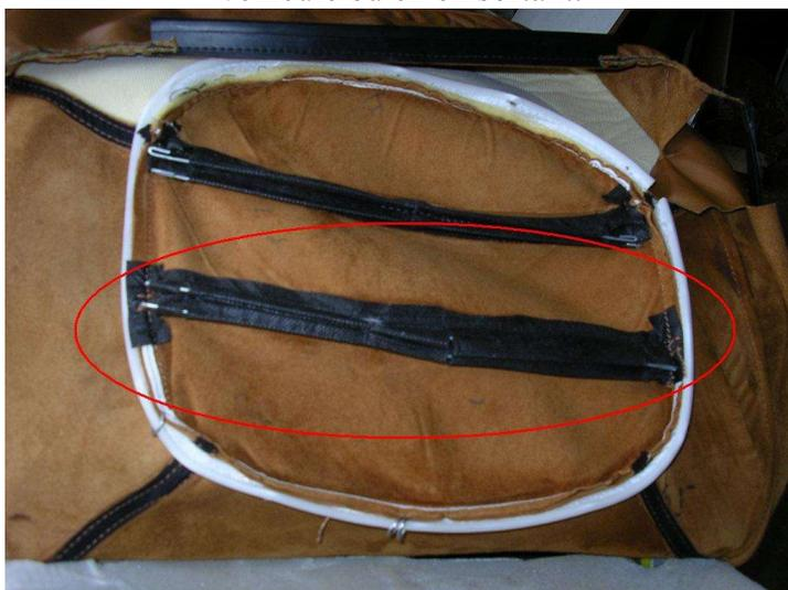
Voici la gaine en tissu entourant la tige métallique qui a brûlé à cause des courts-circuits qu'il y a eu au fur et à mesure des mises en route du siège chauffant :
