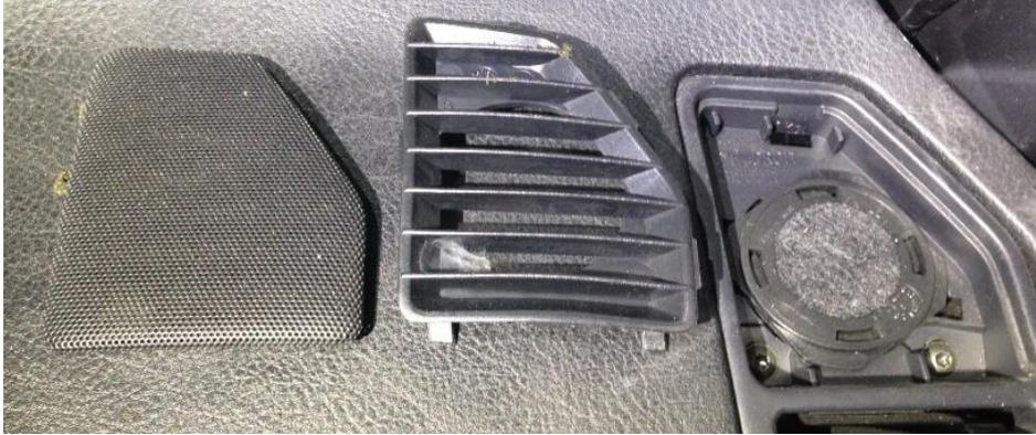
Si la mousse qui se trouve entre la grille et cache tweeter est désagrégée la remplacer par un filtre à poussière que l'on trouve sur les aspirateurs.
