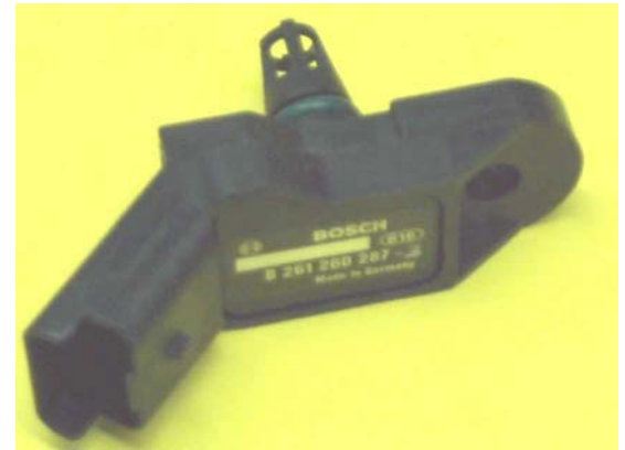
Capteur de pression absolue avec sonde de t° air
