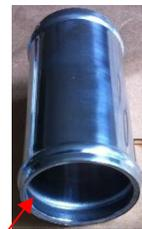
La durite principale étant blessée suite à un frottement contre le connecteur 'masse **TBC**' de l'alternateur a été remplacée par une durite Gates 'souple' raccordée à la partie saine grâce à un manchon.
