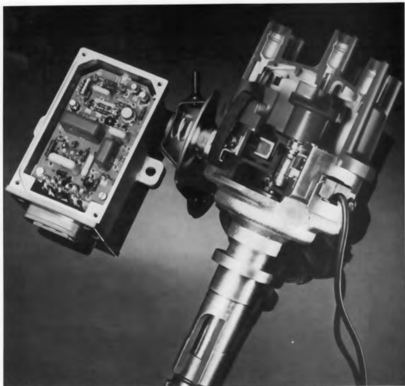
allumage transistorisé sans contact (absence d'entretien) à système d'avance mécanique - tension d'allumage : 30 KV
