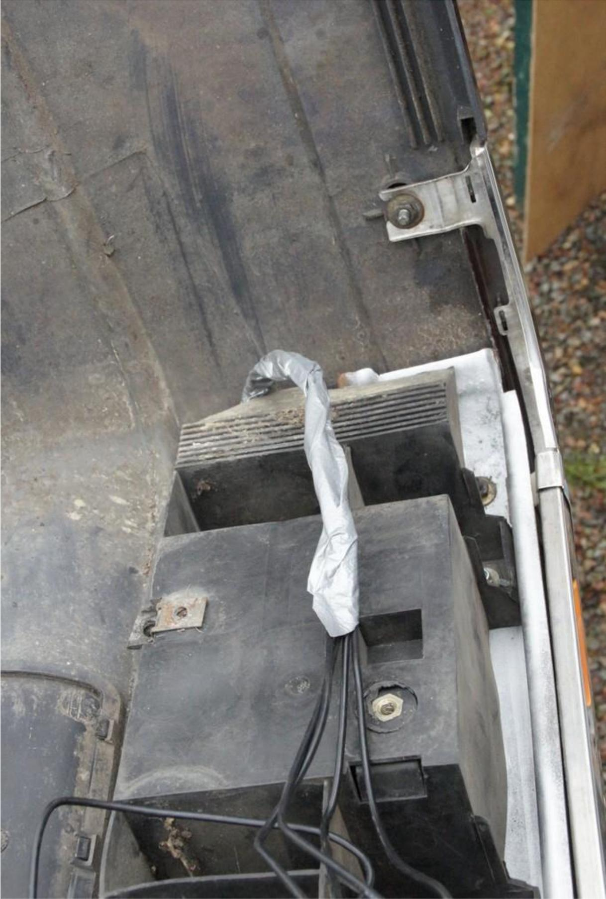
Ensuite, trouver un endroit pour passer le faisceau, il y a un bouchon parfait pour ça, il suffit de faire un petit trou en X au milieu et passer les câbles à travers.
