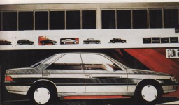
CONTEMPORAIN DU DESSIN ITALIEN (À G.) (DÉBUT 1984) LE PROJET PEUGEOT S'EN DÉMARQUAIT PAR UN VOLUME ARRIÈRE MOINS MASSIF, UNE LUNETTE PLUS ENVELOPPANTE ET UNE MOULURE LATÉRALE PLUS DISCRÈTE.
